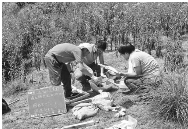
写真215 平成21年9月7日実施墳丘舗装材試験片作成状況 (固めてe土1:土9)
