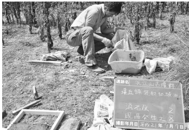
写真218 平成21年9月7日実施墳丘舗装材試験片作成状況 (消石灰2:土8)
