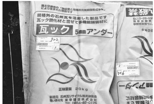
写真400 平成25年度墳丘整備工遺構保護工土舗装材（瓦ンド）
