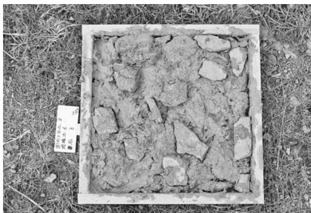
写真223 平成21年10月14日作成墳丘舗装材(固めて土3:土6:石3)
