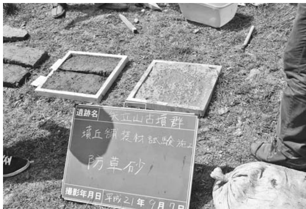
写真219 平成21年9月7日実施墳丘舗装材試験片作成状況 (防草砂10)
