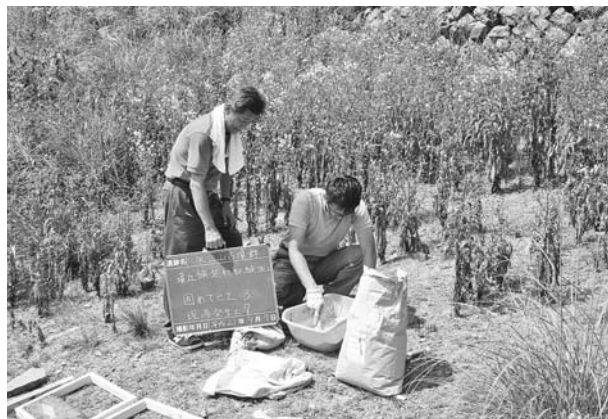
写真216 平成21年9月7日実施墳丘舗装材試験片作成状況 (固めてe土3:土7)
