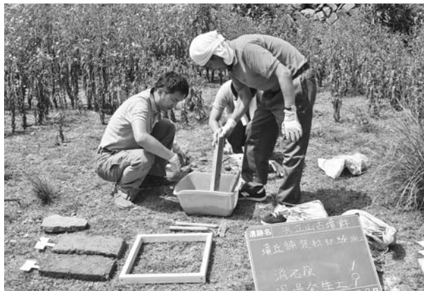
写真217 平成21年9月7日実施墳丘舗装材試験片作成状況 (消石灰1:土9)
