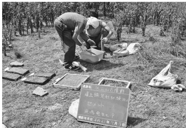
写真220 平成21年9月7日実施墳丘舗装材試験片作成状況 (セメント1:土9)
