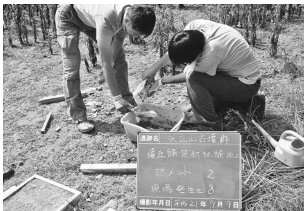
写真221 平成21年9月7日実施墳丘舗装材試験片作成状況(セメント2:土8)
